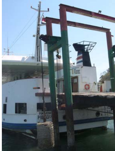
Figura Nº 25. Contacto directo entre la embarcación y la rampa.
